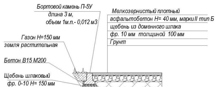
Схема 3 Конструкция покрытия тротуара Примыкание к газону
