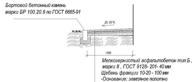
Схема 4 конструкция покрытия откоса
